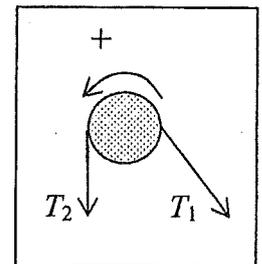
$$T_2 \cdot R \cdot \text{sen}(90) - T_1 \cdot R \cdot \text{sen}(90) = I_{\text{polea}} \cdot \gamma$$
